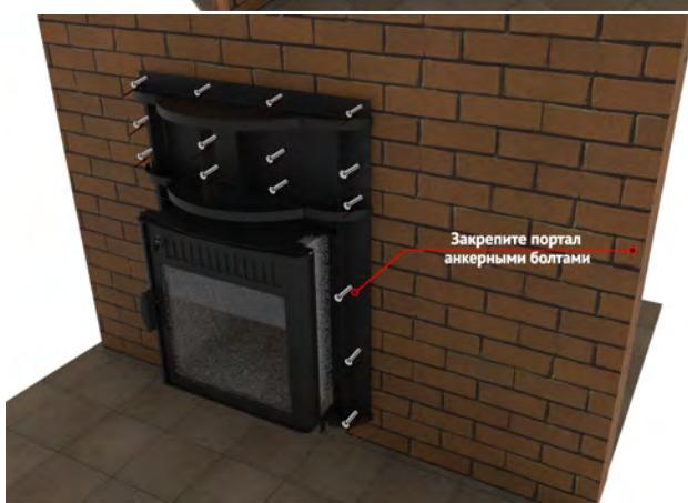
Рисунок 8.2. Схема установки печи
