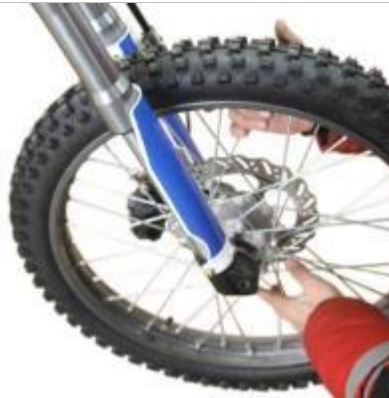
3.3.6. Поставьте колесо между двух передних вилок амортизаторов.
