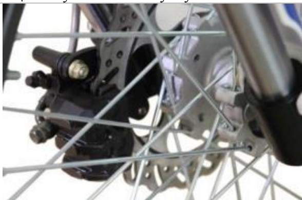
3.3.7. Диск переднего тормоза должен быть установлен между тормозными колодками.
