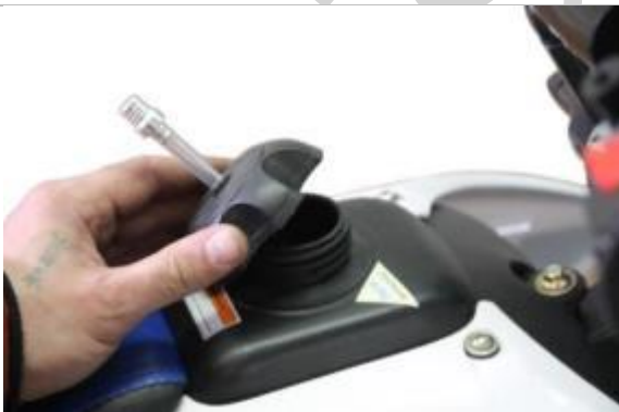
3.10.1. Установите крышку бензобака, как показано на фотографии.
