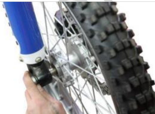
3.3.11. Затяните гайку осевого болта накидным ключом на 17 мм.
