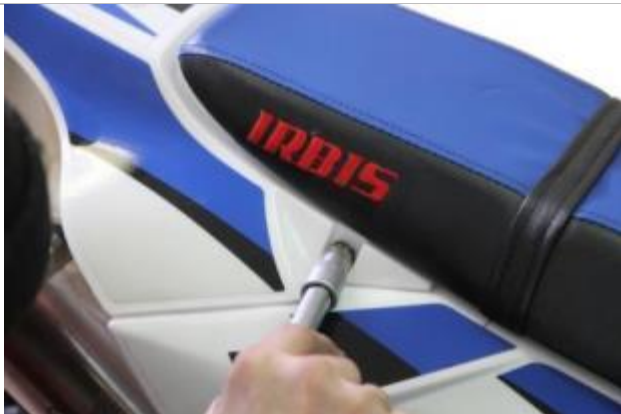
3.9.4. Зафиксируйте сиденье ранее выкрученными болтами в п.3.5.3.
