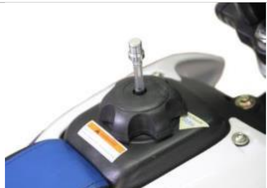
3.10.1. Установите крышку бензобака, как показано на фотографии.
