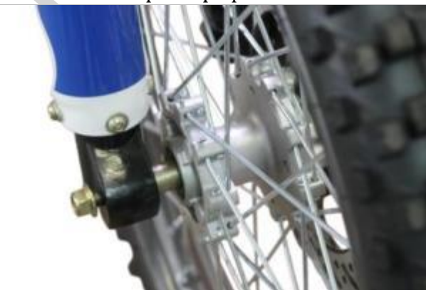
3.3.10. Вставьте осевой болт через втулку в правую вилку амортизатора и накрутите гайку.
