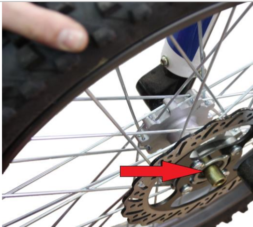
3.3.5. В диск переднего колеса с левой стороны мотоцикла установите втулку.
