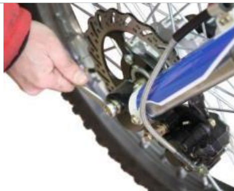
3.3.12. Затяните осевой болт ключом на 14 мм.
