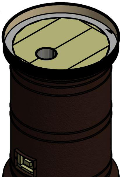
Угловой зазор между шамотом и деталью м5 проложить обрезками супервула и замазать раствором заподлицо с верхом шамота.
