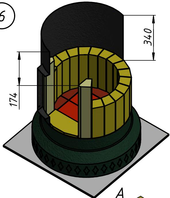
Для облегчения установки топочной дверки в конце процесса сборки, рекомендуется выполнять шаг 6, временно установив дверку на место.
