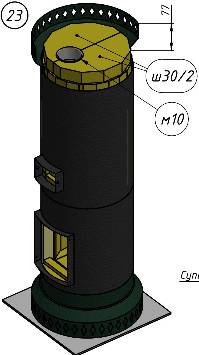
Угловой зазор между шамотом и деталью м4 проложить обрезками супервул и замазать раствором заподлицо с верхом шамота.
