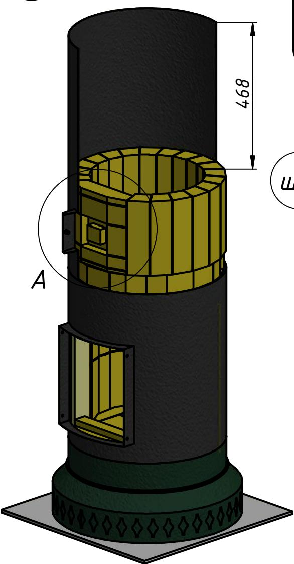
*Расположить детали чистки таким образом, чтобы съёмный элемент ш19 оказался напротив прочистного отверстия кожуха (Меняя местами детали ш16, ш17, ш21 и ш22 + сыграть на швах)*
