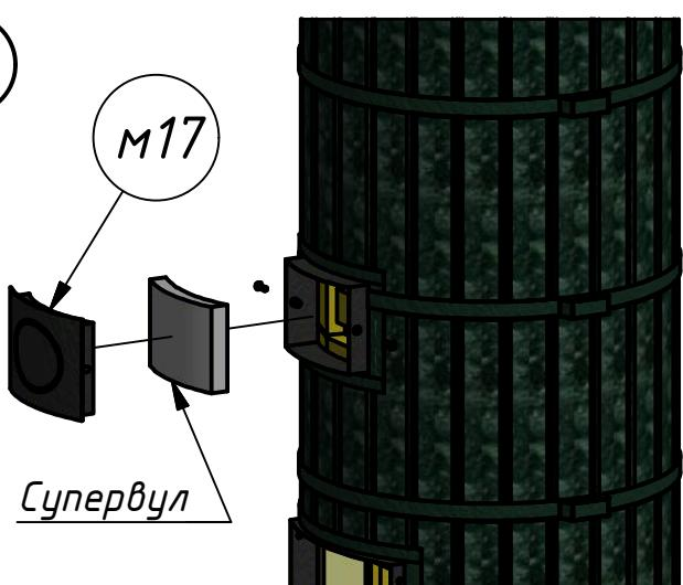
После сборки облицовки внутрь тоннеля прочистной дверки плотно вставить вырезанный с припуском прямоугольник из супервула, после чего установить заглушку чистки и закрепить ее болтами к1 – 2 шт.
