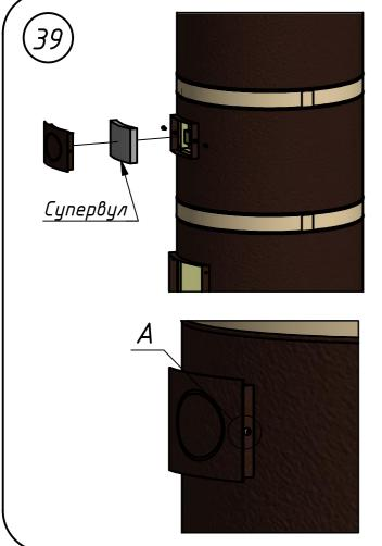
Внутрь тоннеля прочистной дверки плотно вставить вырезанный с припуском прямоугольник из супервула, после чего устанавить заглушку чистки и закрепить ее болтами к1 – 2 шт.
