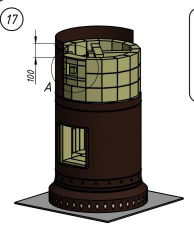
Детали чистки расположить таким образом, чтобы съёмный элемент №27 оказался напротив прочистного отверстия кожуха. (Меняя местами детали 23–26 + сыграть на швах.)
