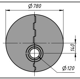
Разметку основания печи удобно произвести, положив на пол разъёмную крышку м6.
