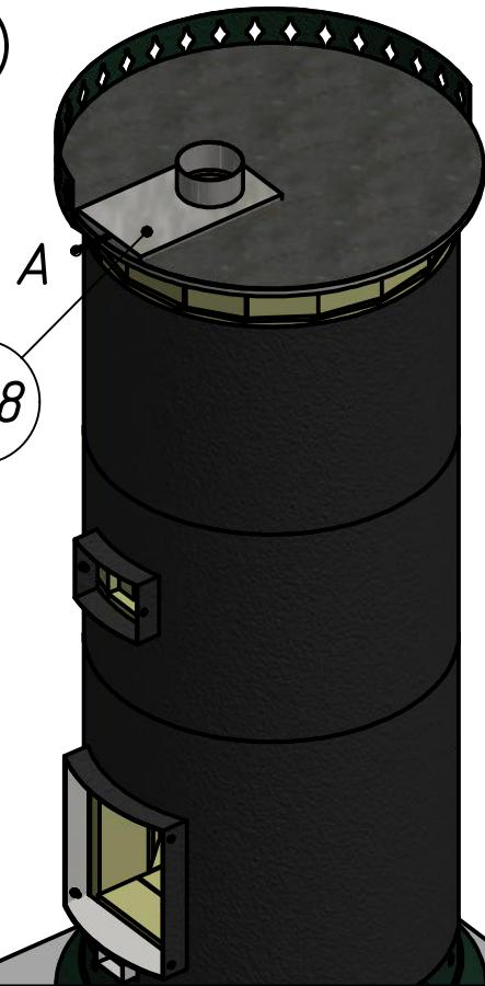
Далее следует примерить и отметить необходимую длину штока шибера м18. Шток должен выступать из верхнего фигурного обрамления корпуса м5 на 30..50мм в закрытом состоянии. Обрезать по отметке шток шибера, снять фаску и сделать пропил на половину диаметра в 4-х мм от края. Установить шибер на место расширенным патрубком вверх.
