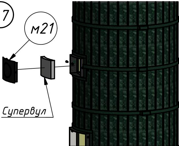
После сборки облицовки внутрь тоннеля прочностной дверки плотно вставить вырезанный с припуском прямоугольник из супервулла, после чего установить заглушку чистки и закрепить ее болтами *k1* – 2 шт.
