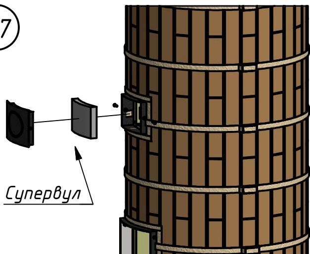
После сборки облицовки внутрь тоннеля прочистной дверки плотно вставить вырезанный с припуском прямоугольник из супервул, после чего установить заглушку чистки и закрепить ее болтами к1 – 2 шт.
