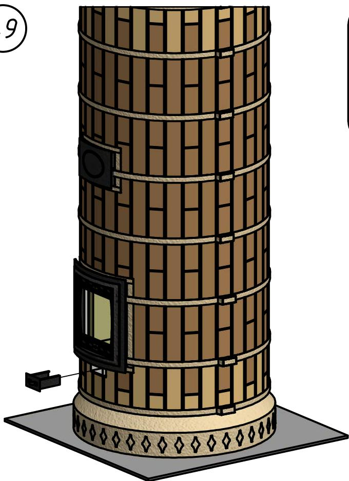
В заключение, установить на место регулятор притока м10 и, при необходимости, увеличить отверстие под дымоход в верхней крышке м6 до нужного диаметра.
