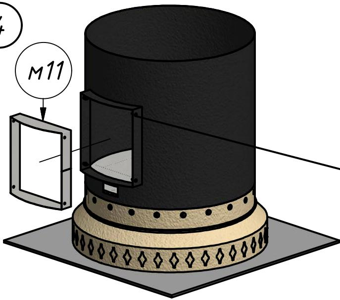
Зашиту тоннеля м11 временно закрепить в тоннеле при помощи болтов K1 - 4 шт.
