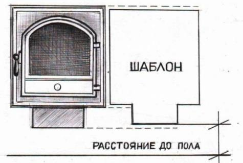
3. Прикладываем шаблон к облицовке и отмечаем, какие части на внутреннем обрамлении необходимо отрезать.
