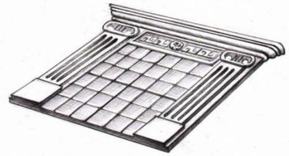
2. Из картона изготовить шаблон дверки печи. При изготовлении шаблона будьте внимательны, так как этот шаблон необходим Вам для точной разметки и реза внутренних панелей обрамления.
