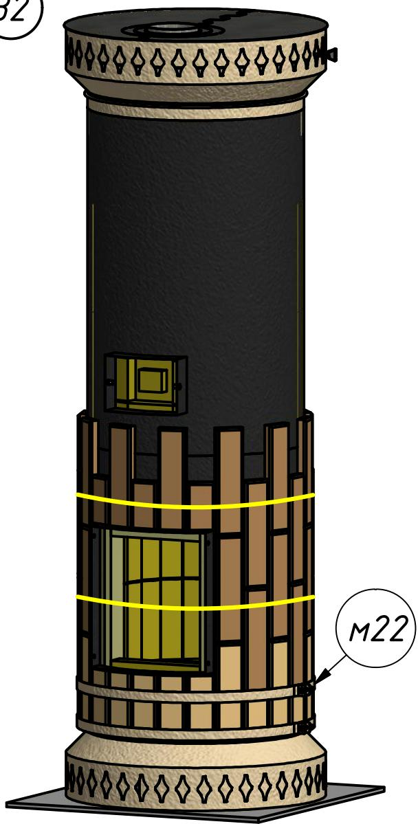
По мере сборки, эластичные жгуты необходимо передвигать вверх для установки следующего ряда плиток облицовки, предварительно зафиксировав предыдущий ряд при помощи хомутов. Замки хомутов рекомендуется располагать друг над другом.
