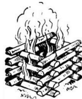
3.2.4 Для розжига печи выложить на подду печи мелконарубленные дрова (толщиной с палец) «колодцем» (см. рис.), к передней стенке «колодца» вертикально заложить щепки и зажечь. Закрывать топочную дверку.
