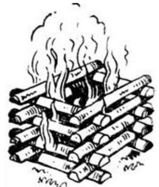
3.2.4 Для розжига печи выложить на поду печи мелконарубленные дрова (толщиной с палец) «колодцем» (см. рис.), к передней стенке «колодца» вертикально заложить щепки и зажечь. Закрыть топочную дверку.
