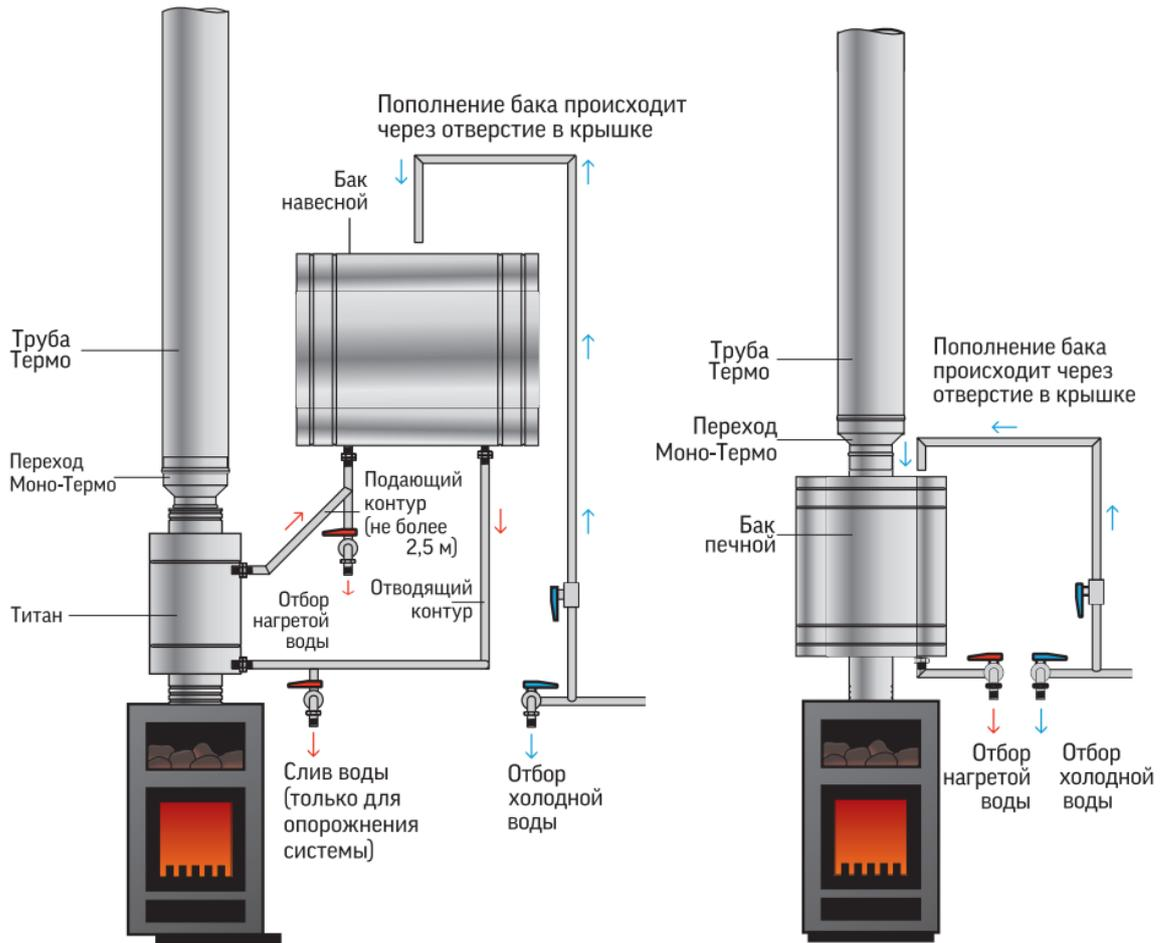
Титан предназначен для нагрева воды. Устанавливается совместно с Бакom навесным.
