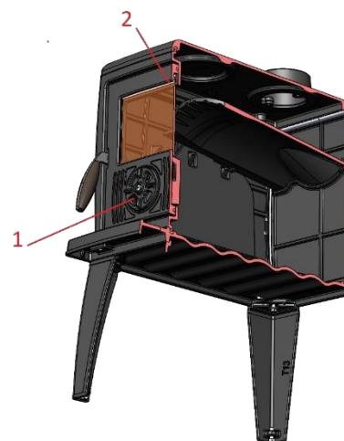
Отопительный прибор предназначен для обогрева жилых помещений. Теплоотдача осуществляется от корпуса и через огнеупорное стекло. Данную печь рекомендуется подключать в дымоход, снабжённый поворотным шибером.
