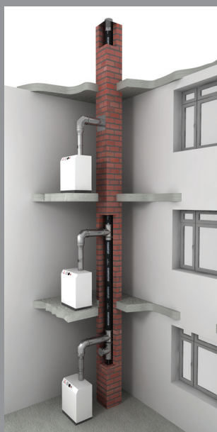
Коллективный дымоход в многоквартирном жилом доме
